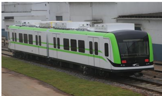
Figura 5: metropolitana CSR Zhuzhou Electric Locomotive dotata di supercapacitori per alimentare i motori elettrici.
